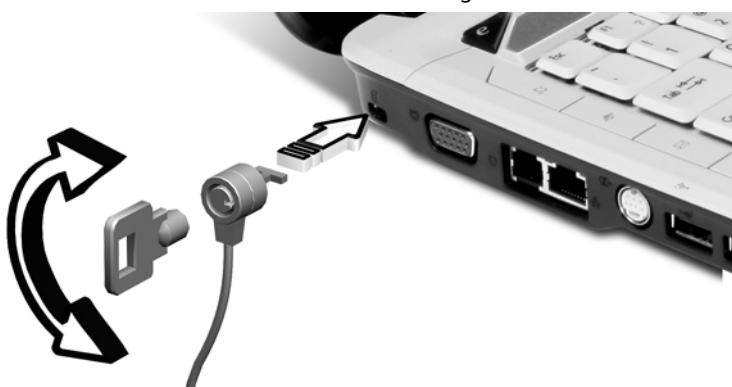
將電腦安全鎖電纜繞著無法移動的物品打個圈，例如，桌子或鎖住的抽屜把手。再將鎖插入鎖孔中，並轉動鑰匙以便上鎖。另外一些沒有鑰匙鎖孔的機型，也可提供使用者來選擇。
